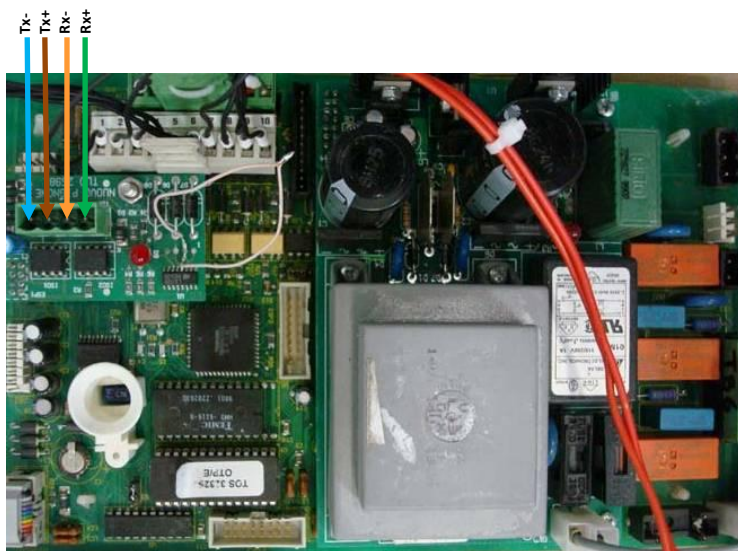
Nuovo Pignone dispenser board
